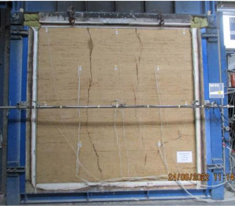
Rissbilder der Stampflehmwand (d = 220 mm) auf der brandabgewandten Seite nach 90 Minuten Brandbeanspruchung vor dem 1. Pendelschlag (links) und nach dem 3. Pendelschlag (rechts).
